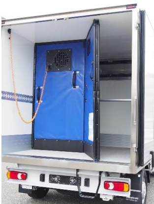
TUSSENWAND MET VENTILATOR
