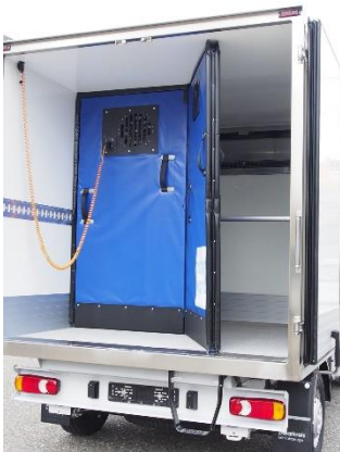
TUSSENWAND MET VENTILATOR
