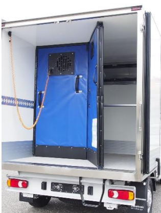
TUSSENWAND MET VENTILATOR
